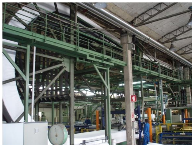
Transporter na krožni žagi, na katerem potuje 60 metrski blok iz mehke poliuretanske pene
