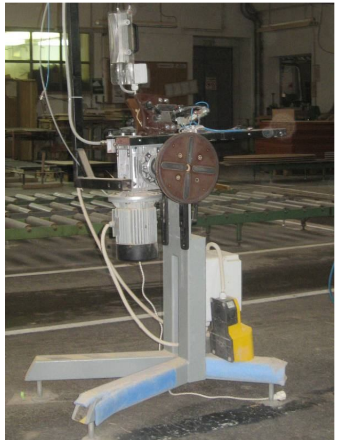
Vertikalna vrtljiva miza za zapiranje roba s furnirjem pri okroglih in ovalnih ploščah
