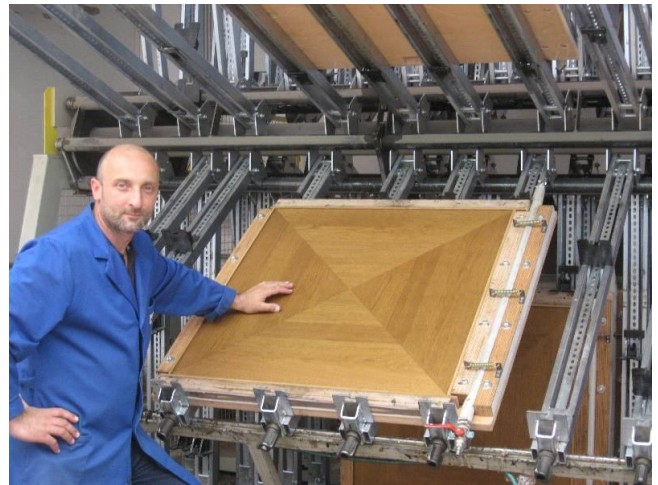
Stiskalnica za lepljenje plošč z masivnimi letvicami
