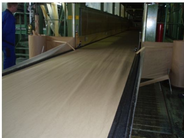
Papir s PE folijo, na katerega se vliva HR visoko elastične pene
