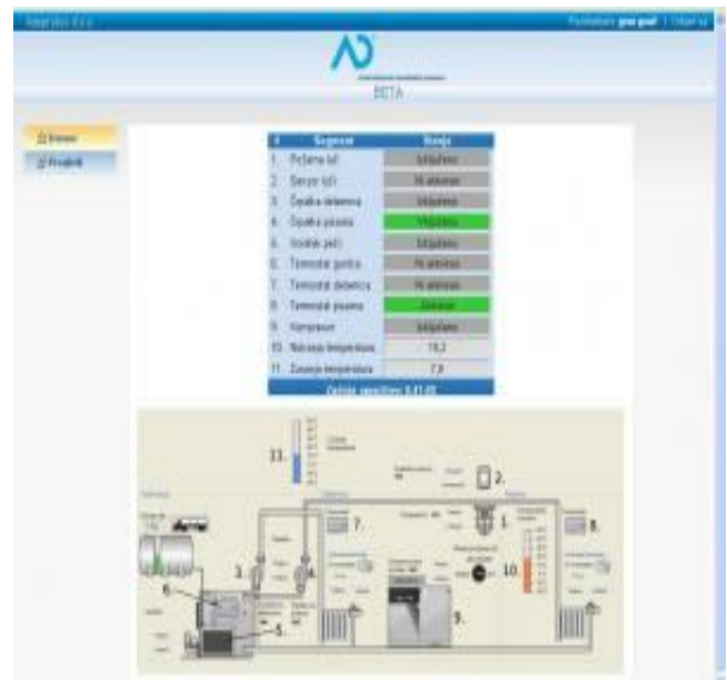
Pogled na prvo stran spletne aplikacije za upravljanje s kotlovnico
